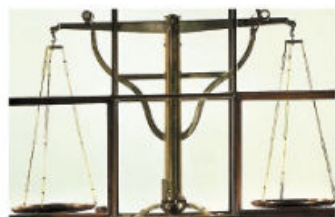
Figura 1.69 Esta balanza fue construida en 1789 especialmente para Lavoisier por el talentoso mecánico francés Jean-Nicolas Fortin (1750-1831), y se encuentra en el Museo de Artes y Oficios en París, Francia. Podía pesar hasta 10 kg con una precisión de 25 mg.
