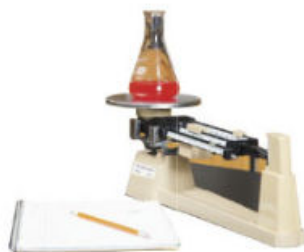
Figura 1.18 Balanza granataria. La sensibilidad de esta balanza es de 0.1 g y su escala de medición está en gramos.
