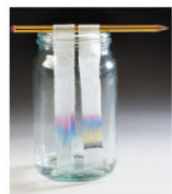
Figura 1.51 Con la cromatografía en papel se separan los componentes de los colorantes.
