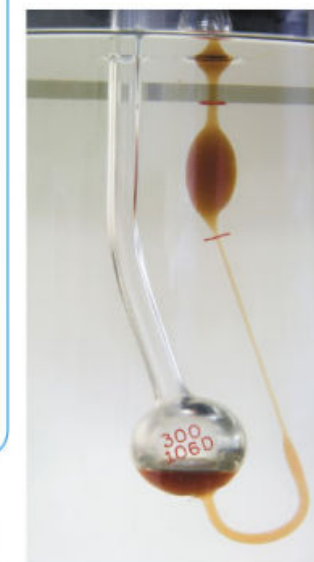
Figura 1.26 Viscosímetro. Este instrumento se emplea en industrias como la del petróleo y las pinturas.
