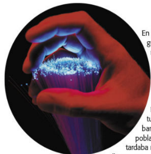
Figura 1.2 La fibra óptica se usa en telecomunicaciones, para la transmisión de datos; en sensores, para medir la temperatura, y en la fabricación de concreto transparente, entre otras cosas. Los materiales con los que se elabora son el vidrio o algún polímero.
