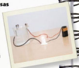
Figura 2.72 Dispositivo para probar la conducción eléctrica.
