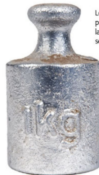
Figura 1.16 En la actualidad se busca redefinir el kilogramo, por ser la única unidad basada en las propiedades de un objeto (una pieza de platino e iridio fabricada en 1879) cuyo desgaste y contaminación pueden provocar imprecisiones.
