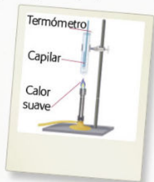
Figura 2.83 Dispositivo para la determinación del punto de fusión.
